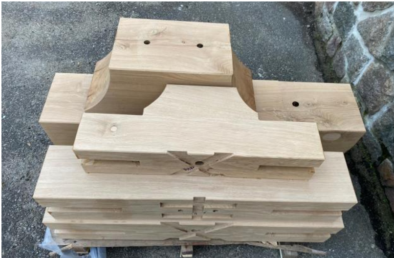
Oberes Foto: die neuen Klöppel für die Glocken Unteres Foto: die vorbereiteten Joche der Glocken
